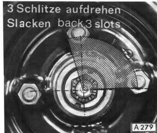
Die Kegelrollenlager dürfen auf keinen Fall unter Vorspannung laufen. Bei richtiger Einstellung muß sich die Sicherungsscheibe noch verschieben lassen.
