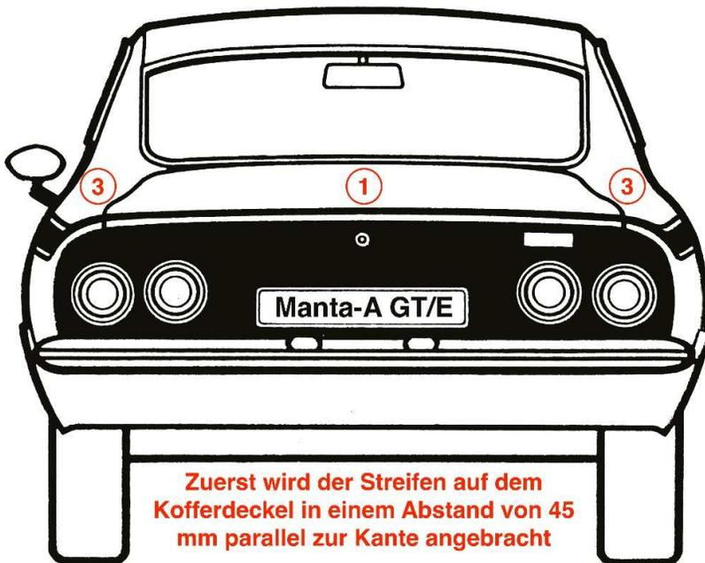
**Zuerst wird der Streifen auf dem Kofferdeckel in einem Abstand von 45 mm parallel zur Kante angebracht**
