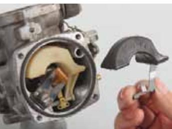
Vollmaterial-Schwimmer (aus Nitrophenyl) von „Stayup“ beugen dem Abtauchen undichter Vergaserschwimmer vor. Zu beziehen sind sie über den norddeutschen Vergaserservice-Betrieb von *Jens-Peter Adam* für eine Reihe
